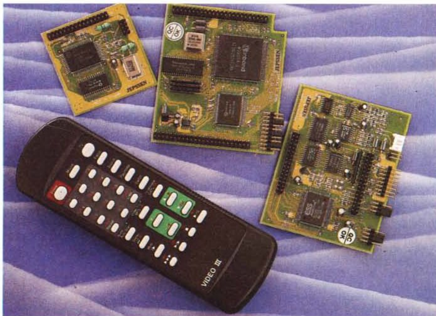
I tre add-on in evidenza; egregia la loro costruzione, utilizzando componenti affidabili e sperimentati. Per il Player MPEG chip custom Winbond, l'audio module è dotato di chip ESS Audiodrive più il classico Yamaha OPL3, infine il decoder televideo con il consueto Philips SAA5246. A lato, invece, il multifunzionale telecomando in dotazione, con cui gestire tutti gli applicativi a corredo; facilmente riconoscibili le aree di intervento specifiche.
